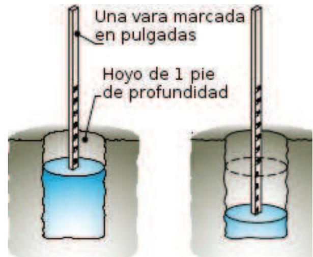
Figura 1: Prueba de drenado.
